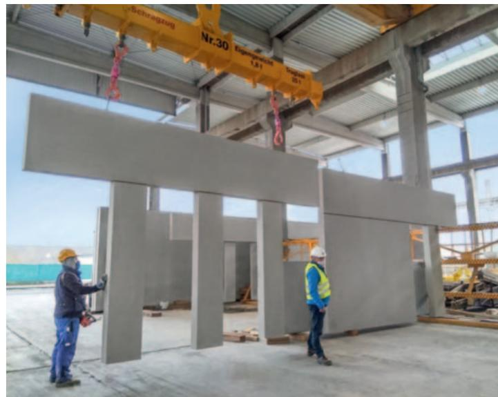
Blick in unser Fertigteilwerk: Die Fassadenelemente mit gewaschener Oberfläche sind bereit zum Transport auf die Baustelle
